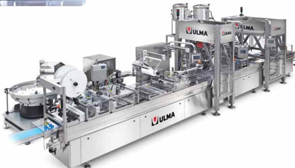
Термоформер с автоматической системой загрузки и дозирования
